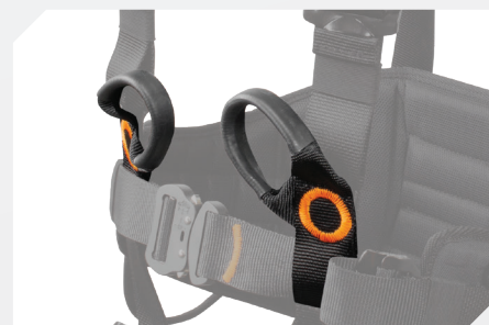
POINTS D'ACCROCHAGE VENTRAL DE MAINTIEN AU TRAVAIL PAR BOUCLES À RELIER
