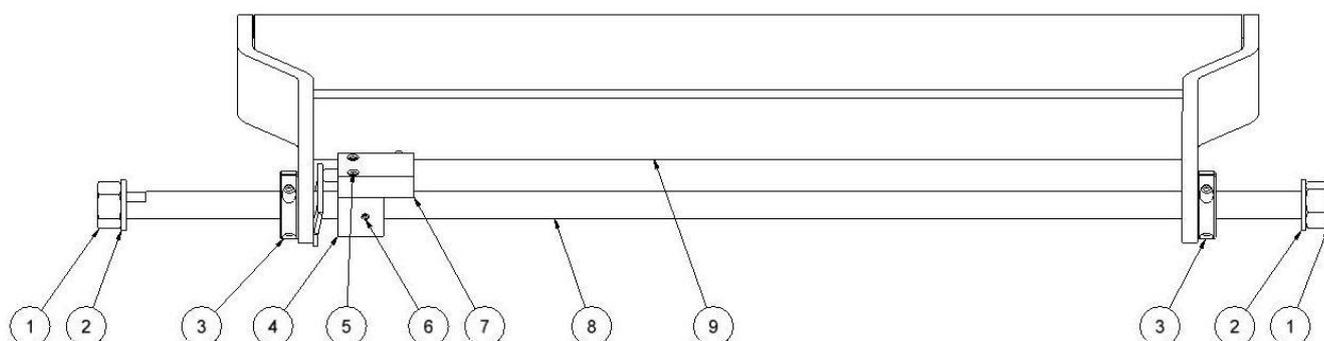
**Mou de câble standard pour une sortie de câble à l'horizontale**
