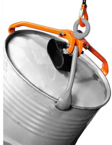
A REMA DG10 hordómegfogó szerkezet segítségével 205 literes (44 imperiál gallonos vagy 55 USA gallonos), felül 585 mm átmérőjű, műanyag vagy acél hordók foghatók be emelőszerkezetbe. Feltételezi a szerkezetileg megfelelő felső perem vagy ajak meglétét a hordón, hogy a REMA DG10 megfogószerkezet megfelelően fogást találhasson és elviselje a hordó és a tartalma súlyát. A REMA DG10 megfogószerkezet kizárolag erre a rendeltetési célra készült, és más célra nem használható.
