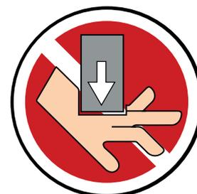
Ne jamais placer les mains, les doigts ou les pieds entre l'appareil de levage et la charge.
