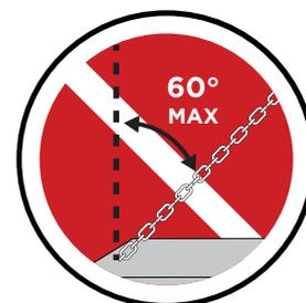
L'angle de levage bêta ne doit jamais dépasser 60°.
